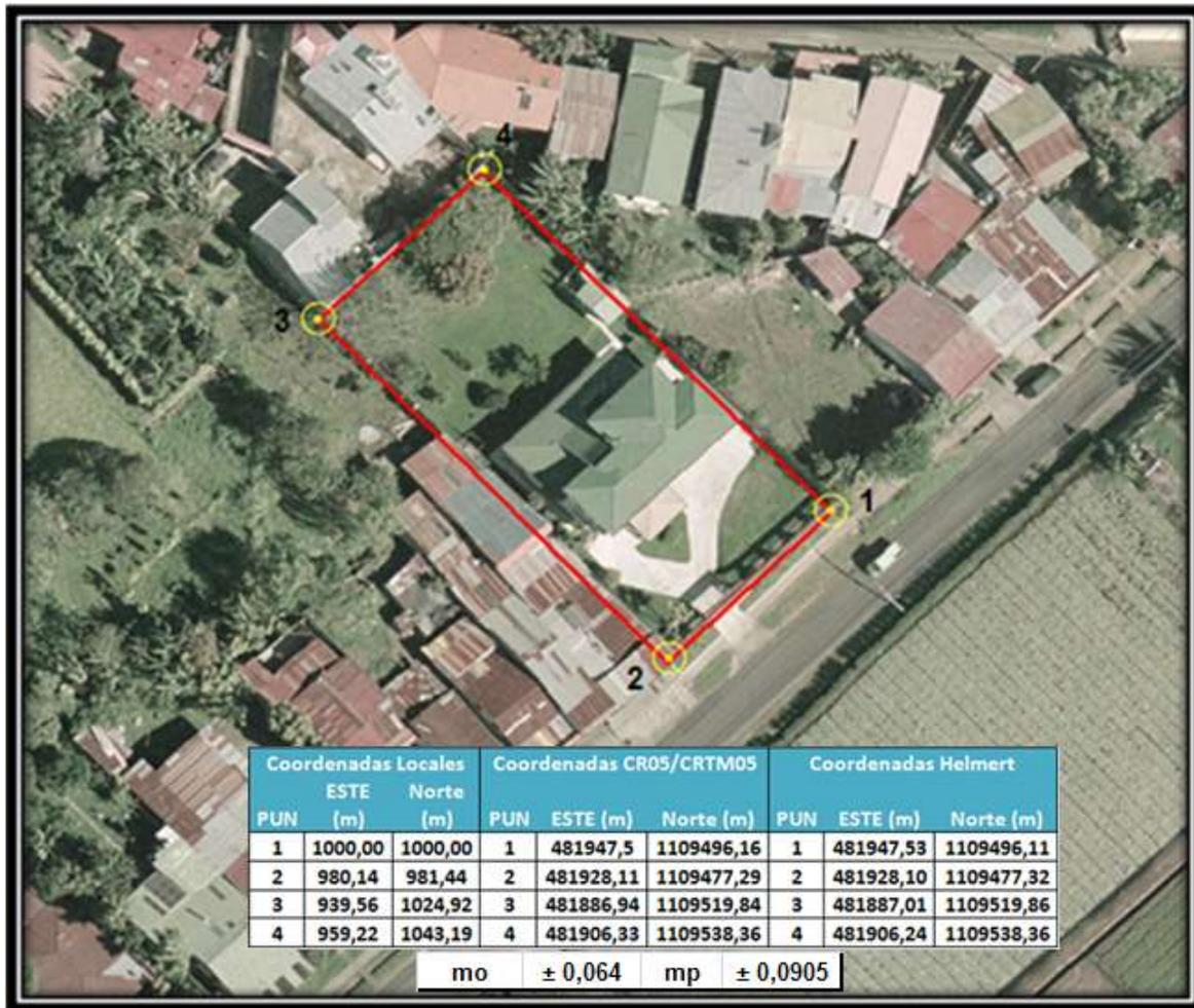
**Figura 15. Plano de agrimensura digitalizado, montado sobre la ortofoto y listado de coordenadas CR05/CRTM05 leídas y ajustadas**
