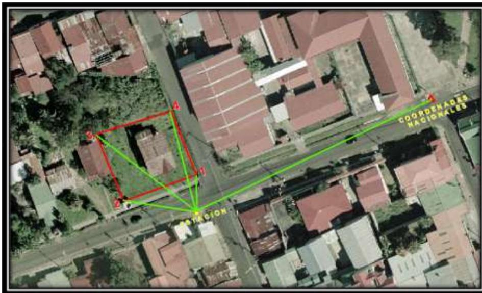
**Figura 19. Ejemplo de enlace de la Red Nacional por métodos Topográficos**
